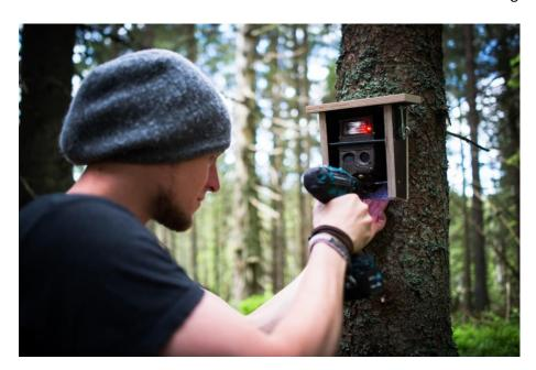
Die Kamerafalle wird in einer definierten Höhe über dem Boden befestigt. Zur zuverlässigen Detektion von Rotwild, aber auch von vielen kleineren Tierarten, hat sich eine Höhe von 50 cm bewährt. An schief gewachsenen Baumstämmen oder im steilen Gelände muss der Neigungswinkel der Kamera mit Hilfe eines Keils zwischen Häuschen und Baumstamm angepasst werden. Nach der Anpassung sollte die Sichtachse der Kamera parallel zum Gelände verlaufen.
