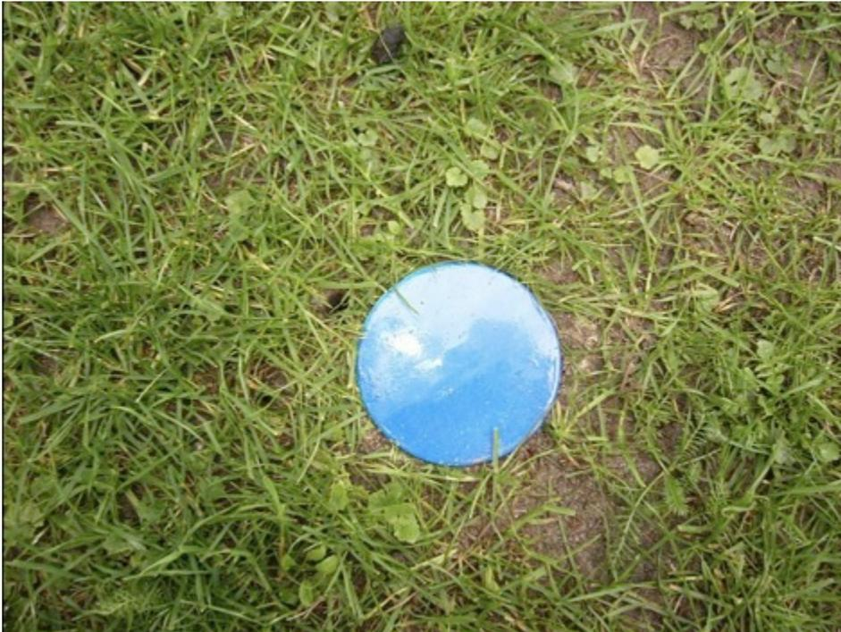
**Abbildung 13: Mit blauem Erdnagel markierter Probepunkt.**
