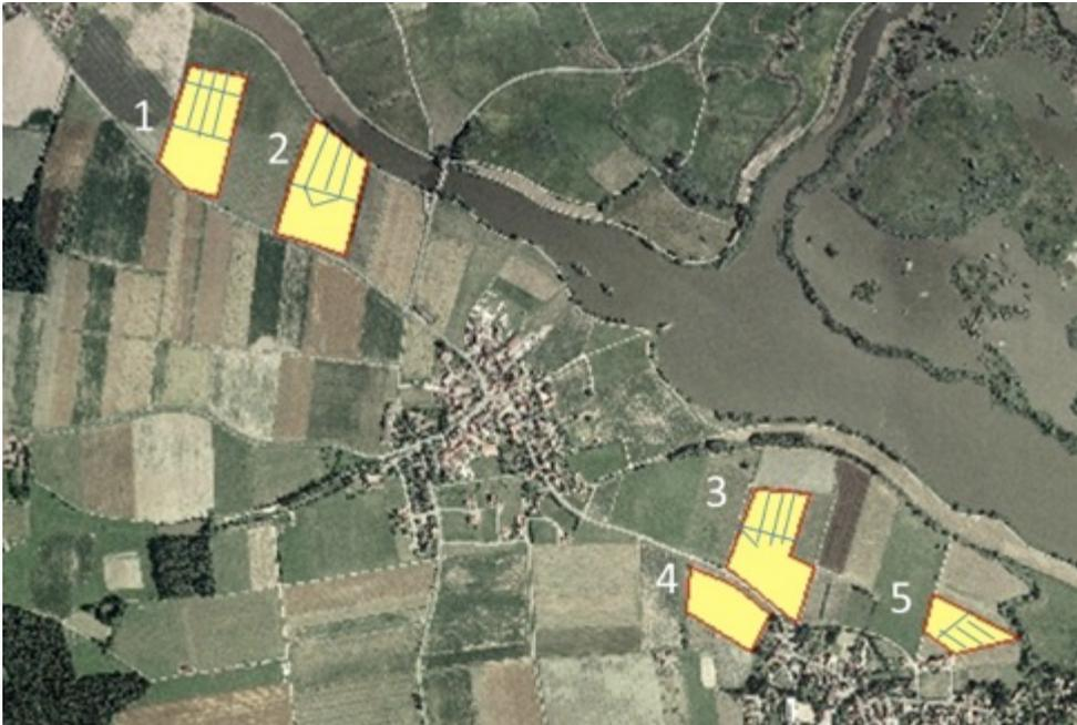
**Abbildung 70: Aufteilung der Maisfelder mit Überspannungen und zusätzlichen Querspannungen zum Schutz der Felder vor Gänsen 2011** (Geobasisdaten © Bayerische Vermessungsverwaltung 2012)
